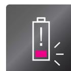
**Allarme batteria scarica a 10V e spegnimento a 9,5V**
